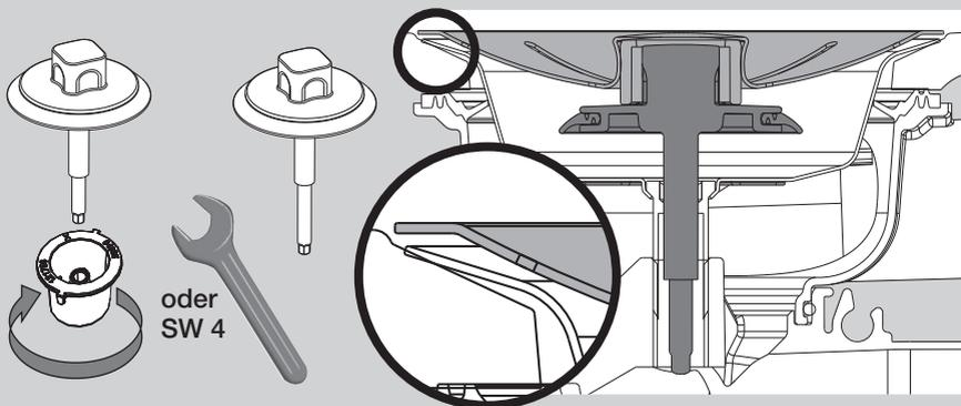
Die Schraube wieder 1,5 Umdrehungen hinein drehen. Jetzt ist InFino® PushControl optimal eingestellt.
